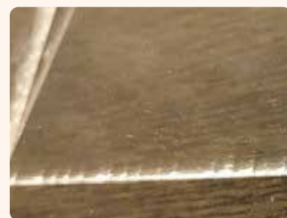
アルコールが垂れ落ちて足元にひび割れが発生している。
